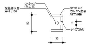
フレーム平面詳細図(配線挿入加工部) S=1/5
