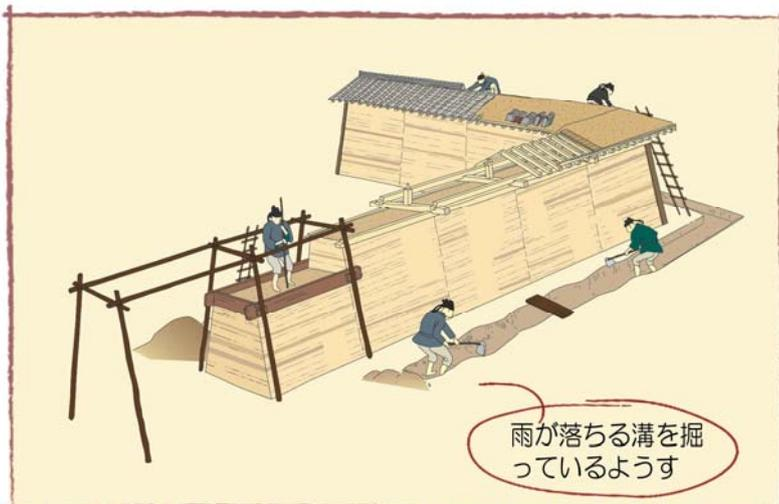
土を固く叩きしめながら造る築地塀の工事の想像図
