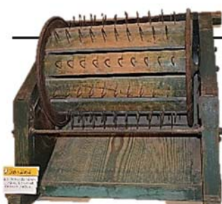
【足踏み脱穀機】 足でペダルを踏み、金具つきのドラムを回して、稲から籾(もみ)を取った。
