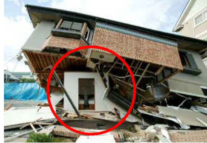
倒壊実験後の耐震シェルター
