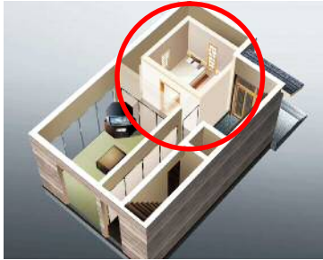
耐震シェルター設置イメージ図
