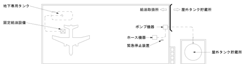
第15-2図 固定給油設備を用いて給油する航空機給油取扱所の例
