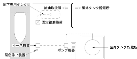
第15－7図 固定給油設備を用いて給油する船舶給油取扱所の例
