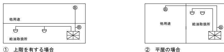
第14-1図 他用途に自動火災報知設備が設置されていない場合の例
