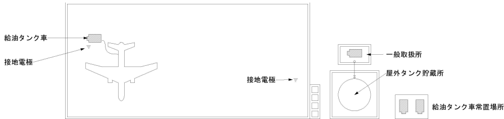
第15-5図 給油タンク車を用いて給油する航空機給油取扱所の例
