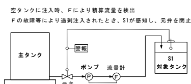
第 4 - 8 図 流量計・液面センサーによる元弁閉止設備を設置した例
